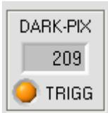
Die aktuelle Anzahl der abgedunkelten Pixel (DARK-PIXEL) wird in einem numerischen Anzeigefeld dargestellt. Ferner wird über eine Orange LED angezeigt ob die Triggerbedingung erfüllt ist.
