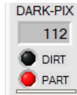
Die aktuelle Anzahl der abgedunkelten Pixel (DARK-PIXEL) wird in einem numerischen Anzeigefeld dargestellt. Ferner wird über eine rote LED angezeigt, dass ein Schmutz-Partikel detektiert wurde.
