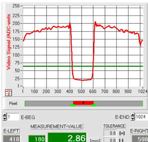
Video Schwelle niedrig, Objekt erscheint schmaler in der „Schattenwurfzone“. Messwert = 180 Pixel. Der Messwert in µm ergibt sich hieraus durch Multiplikation der Pixelzahl mit dem jeweiligen Pixelabstand (pixel-pitch).
